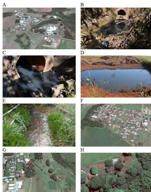
Figura 1. Possíveis pontos de impactos negativos na balneabilidade da cachoeira do Rio São Tomás. A: área industrial; B e C: lançamento de resíduos clandestinos oriundos da área industrial; D: resíduos de granjas na área de contribuição da cachoeira do Rio São Tomás; E: Lançamento de efluentes tratados por uma das empresas localizadas na área industrial, seta vermelha indica efluente e seta azul, fluxo do corpo hídrico; F: área urbanizada sem saneamento básico; G: instituto de ensino sem tratamento adequado de resíduos; H: granja de suinocultura da instituição de ensino sem tratamento adequado de resíduos. Fonte: A, F, G e H obtidas por meio do Google Earth ; B, C, D e E: autores.
